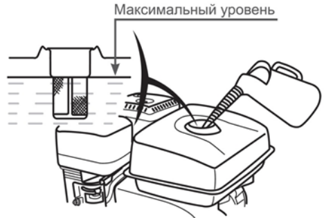
Рис. 7 Максимальный уровень топлива в топливном баке
