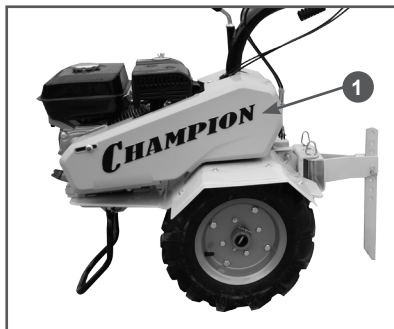
Рис. 10 Кожух защитный ремней 1. Кожух защитный ремней
