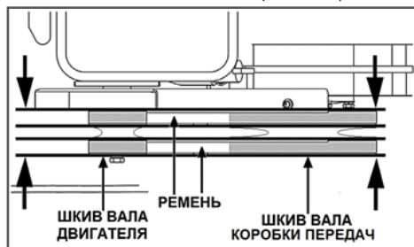
Рис. 23 Проверка соосности шкивов
